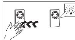
Режим программирования включается тройным нажатием на соответствующую клавишу устройства. В зависимости от конкретного устройства потребуется трижды нажать на клавишу для программирования или дотронуться до сенсорной поверхности.
