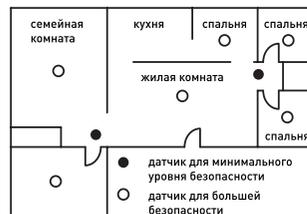
2 | Размещение датчиков в многоэтажных домах.
